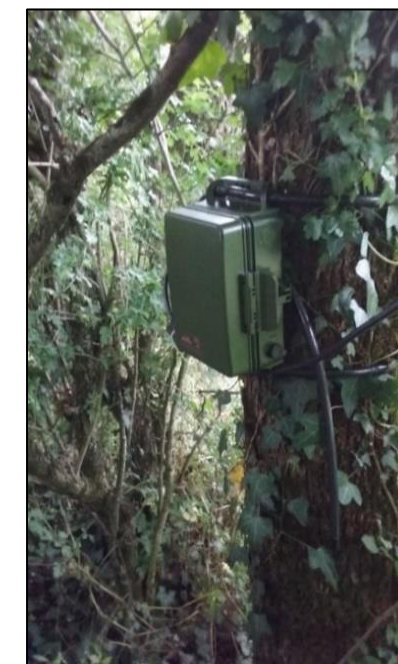
Figure 212 : Exemple d'installation d'enregistreur continu SM4BAT (Crédit photo : NCA Environnement, 2020)
